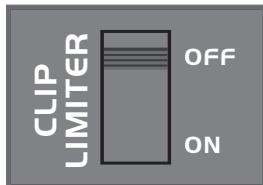
如下图当开关处于ON时，压限打开，此时如果输入信号过大，压限电路会自动控制整机增益减小失真，同时控制平均输出功率,但不会影响到峰值功率的短时输出,保护扬声器的同时又能保证音乐的动态。
