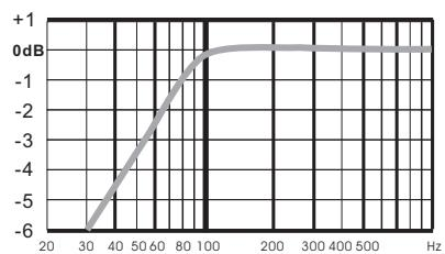
当低切开关处于LF 25Hz时，相当于在输入电路串联一个25Hz的高通滤波器，只对低于25Hz的信号进行衰减。如下图所示：
