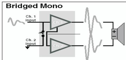
**⚠** 桥接连接模式时，信号不能由2（B）声道输入，并检查所有的接线，确保输出线与输入端隔离。SPEAKON输出的1+和2+，1-和2-是在本机内部不相连接的，请接线时不要将它们并接，尤其是桥接模式，会对本机造成损坏。
