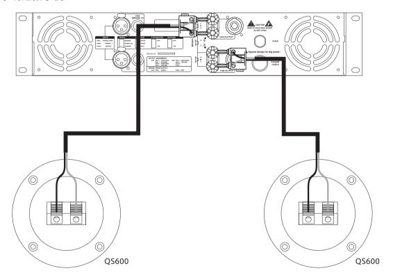
▲ 注意:连接系统时注意扬声器与功放的输出阻抗相匹配。 ▲ 注意:保持整个系统内的扬声器和功放的极性正确连接。
